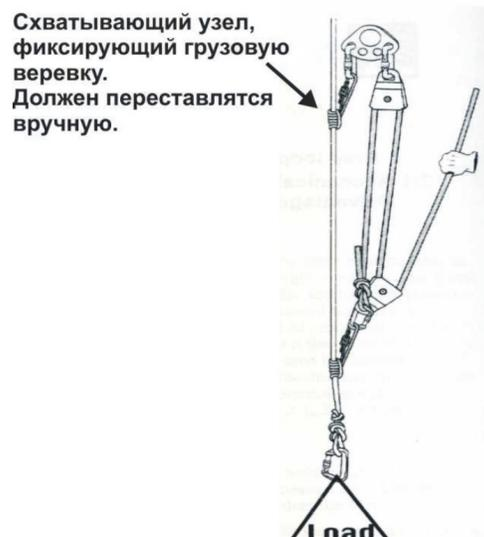
Отдельный полиспаст прикрепляется к грузовой веревке схватывающим узлом. В этой системе для предотвращения обратного хода грузовой веревки требуется фиксирующий схватывающий узел, который необходимо передвигать вручную. Для этого нужен отдельный человек.
